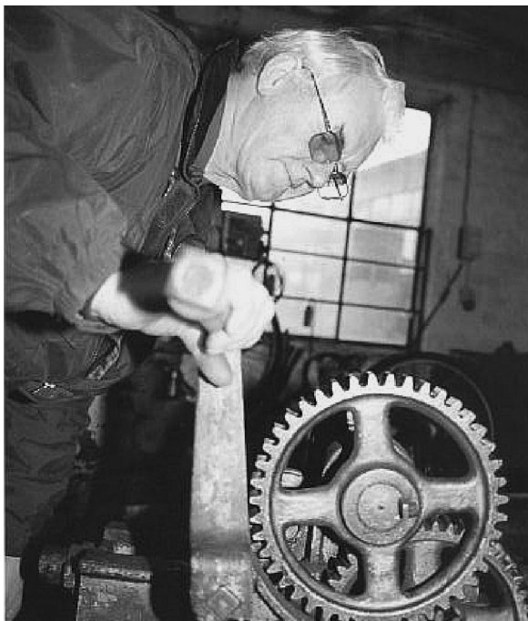
Håndvalsen fra 1800-tallet er jævnligt i brug. Hvor går man ellers hen og får valset et 4 m langt 10 x 40 mm fladjern – på den høje led?
